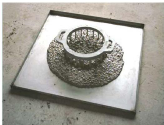
Infine, utili indicazioni sulla resistenza alla segregazione del calcestruzzo potranno essere desunte mediante la prova di **“resistenza alla segregazione al setaccio” (SR: EN 12350-11)**.
