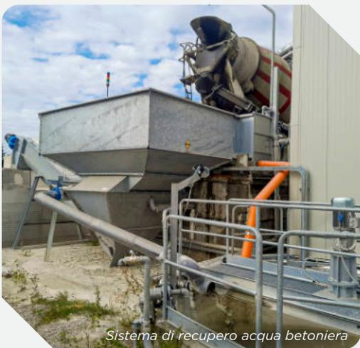
*Sistema di recupero acqua betoniera*
