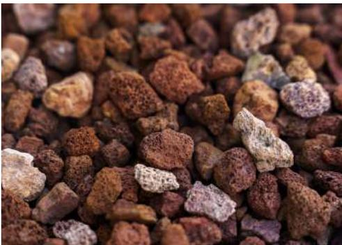
I **calcestruzzi leggeri** hanno massa volumica inferiore a 2000 kg/m<sup>3</sup>, minore di quella (solitamente 2250-2400 kg/m<sup>3</sup>) dei conglomerati cementizi ordinari, conseguenza della presenza all'interno del calcestruzzo di un sistema di vuoti ottenuto:
