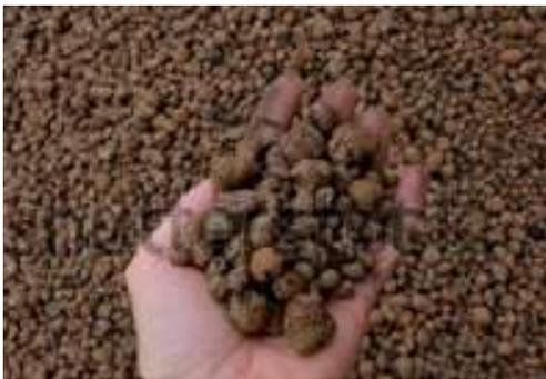
Relativamente alla resistenza a trazione, il calcestruzzo leggero possiede valori inferiori di questa caratteristica rispetto a quelli di un conglomerato ordinario di pari resistenza a compressione. In linea di massima, la diminuzione della resistenza a trazione, almeno per i calcestruzzi leggeri strutturali (con pomice o argilla espansa), è dell'ordine del  $20\text{-}30\%$  rispetto al valore del calcestruzzo ordinario di pari resistenza a compressione.
