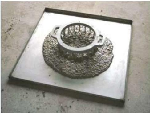
Infine, utili indicazioni sulla resistenza alla segregazione del calcestruzzo potranno essere desunte mediante la prova di “resistenza alla segregazione al setaccio” (SR: EN 12350-11).
