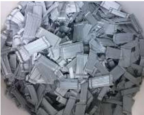
Per quanto concerne le fibre utilizzabili come rinforzo nel calcestruzzo esse debbono essere marcate CE e conformi alla norma UNI EN 14889 parte 1 e 2 rispettivamente per quelle in acciaio e polimeriche. Le principali proprietà delle fibre che influenzano in termini di prestazioni reologiche e meccaniche il calcestruzzo sono:
